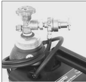
Figure 5 - Raccordement de tuyau et de régulateur
